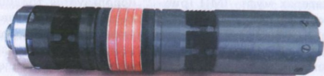
Рис. 4. Проходной шплисовый пакер ППШ-93-70 SARMAT® с внешним диаметром 93 мм и с проходным отверстием 70 мм в сборе с адаптером
